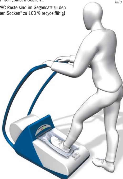
Der Benutzer setzt seinen Schuh in die Öffnung des GaloMat® und bekommt automatisch innerhalb von 7 Sekunden eine spezielle PVC-Folie um den Schuh geschlumpft. Die Schrumpffolie sitzt fest um den Sohlenbereich und löst sich nicht beim Gehen.
